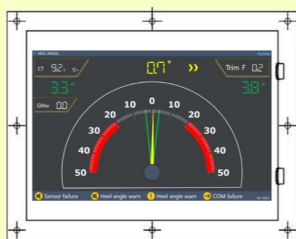
操舵室前壁などに設置する壁掛型 (10.4inch)
